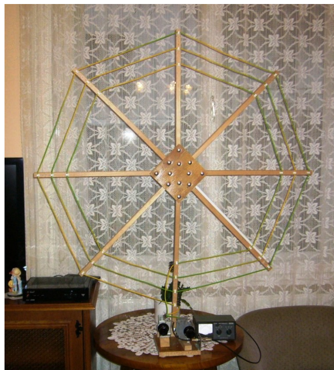
11. ábra. A többmenetes mágneses hurokantenna
