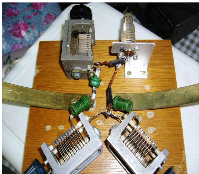
6. ábra Az 50 MHz-es hurok csatlakozása az illesztő elemekhez
