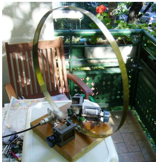
5. ábra Az elkészült 50 MHz-es mágneses hurokantenna bemérés alatt
