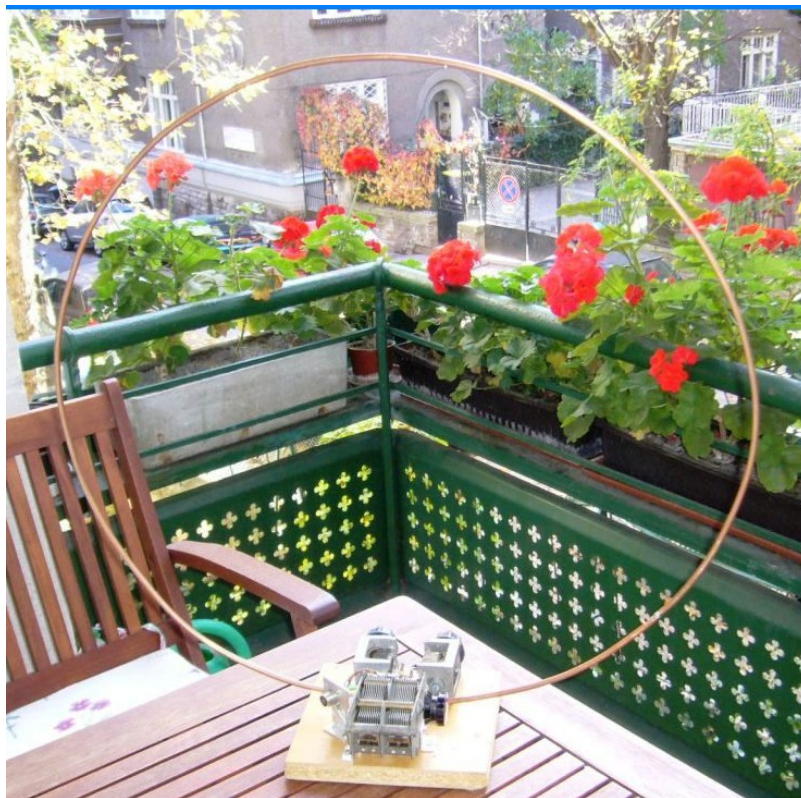
3. ábra. A megépített 21 – 24,9 - 28 MHz-es mágneses hurokantenna
