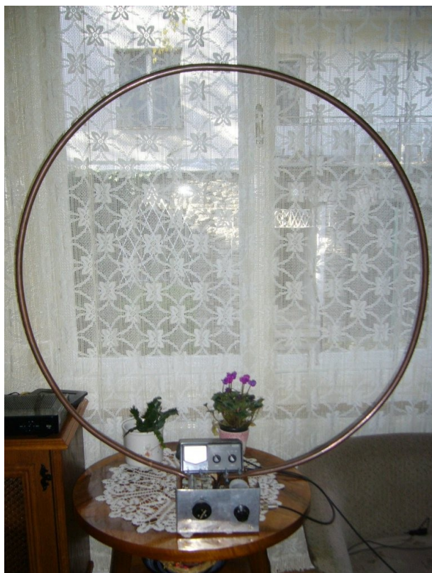
8. ábra. A rézcsőből készült Indoor Loop 7-18 MHz-re
