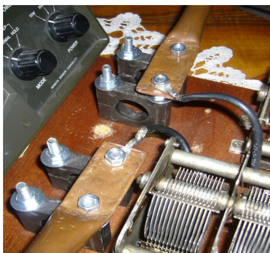
7. ábra. A 18 MHz-re is használható rézcső hurok csatlakozása
